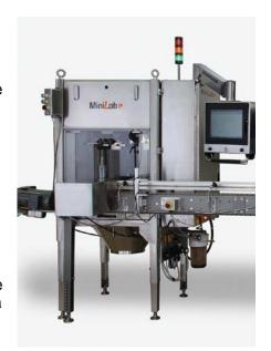
El **MiniLab P** mide envases de diferentes tamaños (con el mismo tamaño de acabado) sin requerir un cambio de la rutina de trabajo. El cambio de piezas de trabajo es mínimo y un cambio completo de las mismas no requiere ningún ajuste mecánico.
