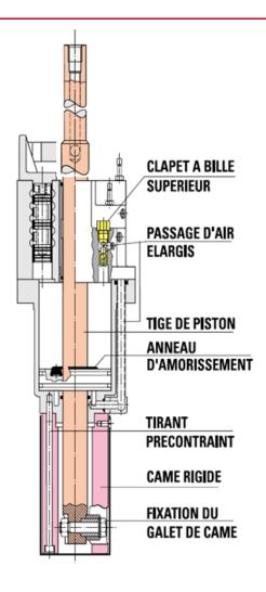
Fond ebaucheur IS 5 ½" & – Compatibilité avec les accessoires et équipements de moules existants. – Conception améliorée de la fixation de la came et du galet de came. 6 1/4" and AIS
