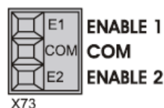
Entrada de seguridad (STO)
